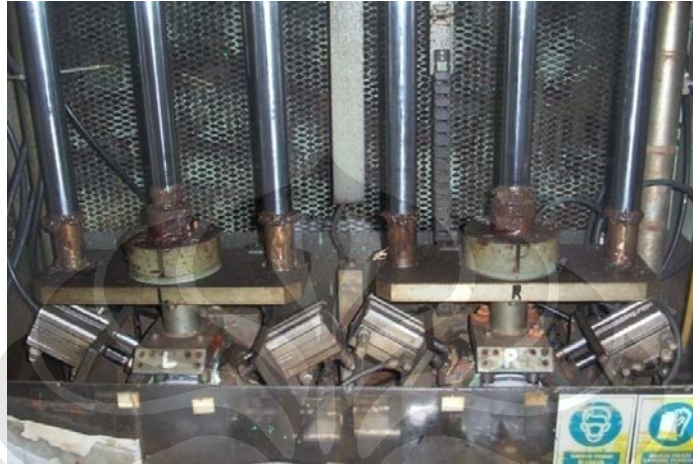
Gambar 3.9. Pengujian kebocoran pada cylinder head
