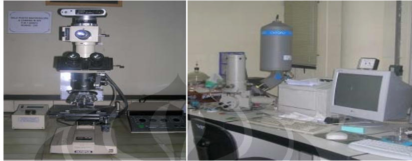
Gambar 3.6. (a) Mikroskop Optik Olympus, (b) Mesin Uji SEM / EDAX LEO 420i
