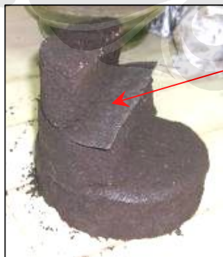
Gambar 3.12. Kondisi 2 ( geotextile diletakkan diatas lapisan ke 2)
