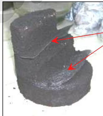
Gambar 3.13. Kondisi 3 ( geotextile diletakkan diatas lapisan ke 1 dan ke 2)
