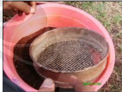
Gambar 3.3. Pengayakan tanah gambut dengan ayakan no. 4
