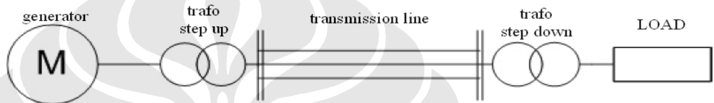
Gambar 2.1 Skema sistem tenaga listrik
